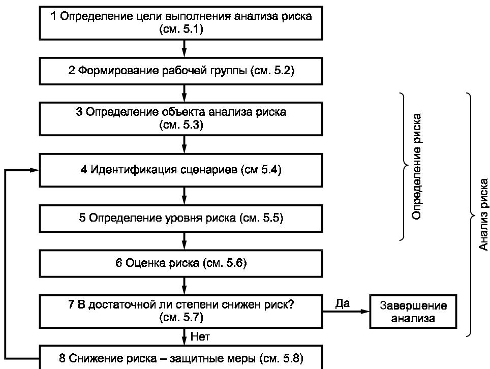
Рисунок 1 — Схема выполнения анализа и снижения риска
